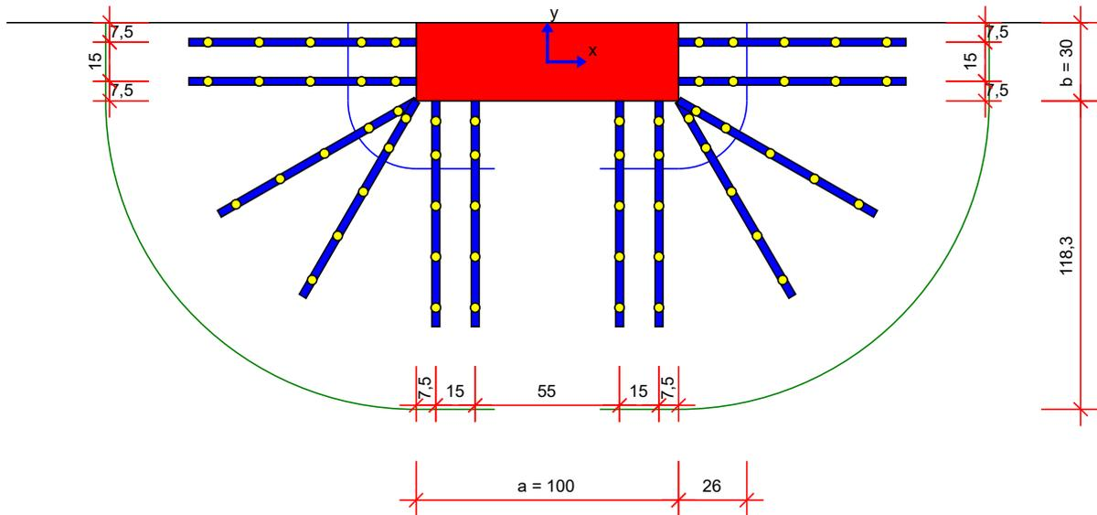
Mindeststablängen:  $l_{bar,min,x} = 388,6 \text{ cm} + 2 \cdot l_{bd}$ ;  $l_{bar,min,y} = 174,3 \text{ cm} + l_{bd}$ ;  $l_{bd}$  Bemessungswert Verankerungslänge
